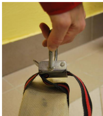
NEPRAVILNO ZAPET CEVNI NOSILEC
