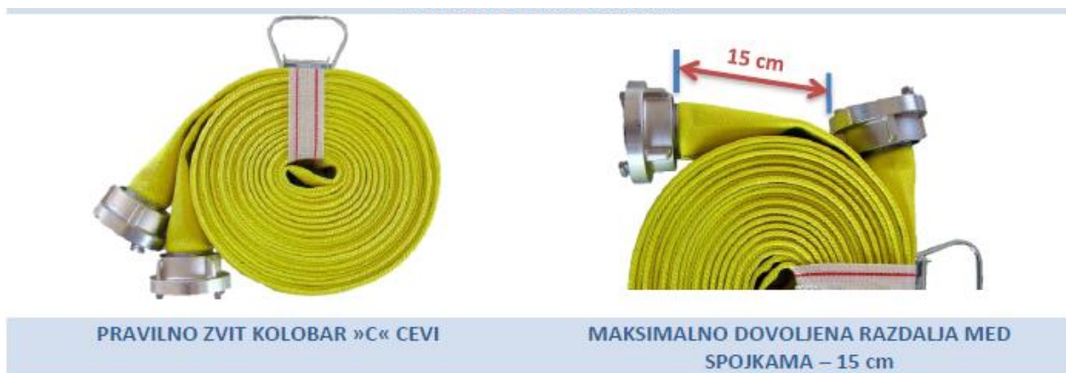
Slika 10: Prikaz pravilno in nepravilno zapetega cevnega nosilca.
